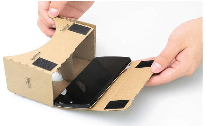
Figure 4: Casque réalisé par Google, « CardBoard » en carton fonctionnant avec un smartphone
